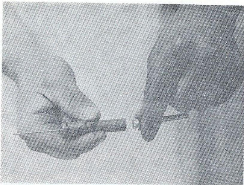
Sl. 64c. Odvrtanje inicijalnog dela
